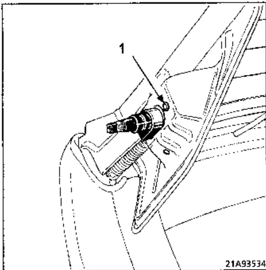
Déposer le rivet de fixation de la commande.
