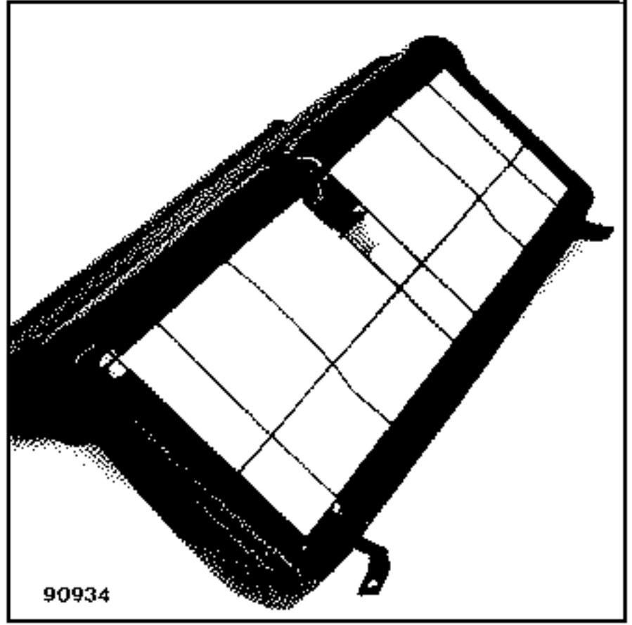
Déclipser les cornières plastique fixant le garnissage du coussin sur l'armature.
