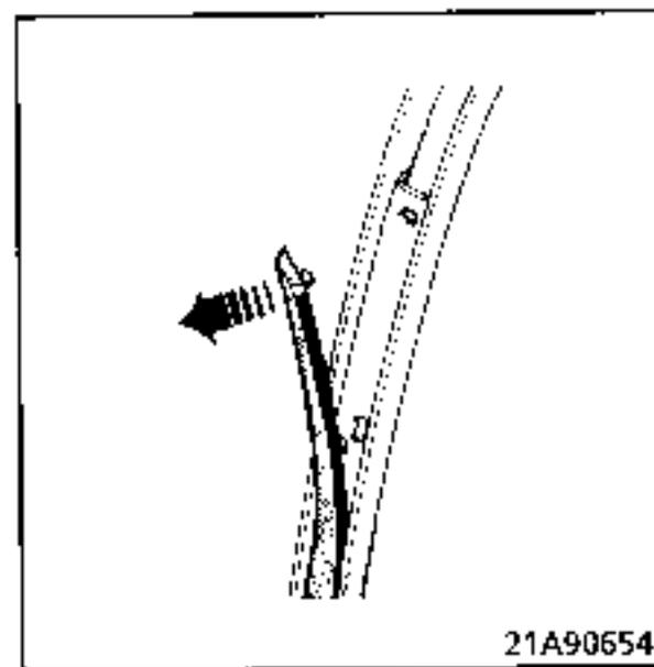
La feuille plastique se dépose en coupant le mastic à l'aide d'un cutter.
