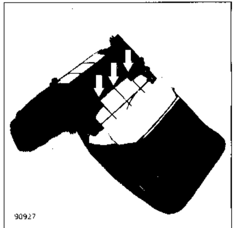
Dégarnir le dossier en coupant les agrafes type "nez de porc", après avoir repéré leur emplacement sur l'armature (pour la repose).
