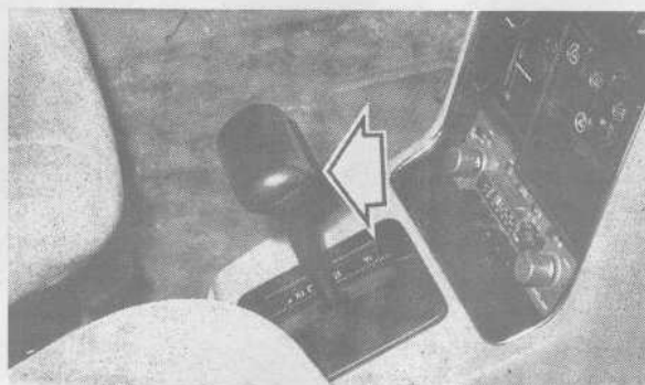
Sélecteur de vitesses et déverrouillage du levier (pour positions P, R, 1 re )
